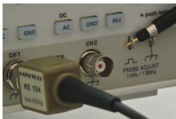
ca. 0,2 V<sub>SS</sub> für Tastteiler 10:1. Diese Spannung entspricht einer Bildschirmamplitude von ca. 4 DIV Höhe, wenn der Eingangsteilerschalter auf den Ablenkkoeffizienten 5mV/DIV eingestellt ist.
