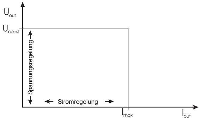
Im Bild erkennen Sie, dass die Ausgangsspannung  $U_{out}$  unverändert bleibt und der Wert für  $I_{out}$  immer größer wird (Bereich der Spannungsregelung). Wird nun der eingestellte Stromwert  $I_{max}$  erreicht, setzt die Stromregelung ein. Das bedeutet, dass trotz zunehmender Belastung der Wert  $I_{max}$  nicht größer wird.
