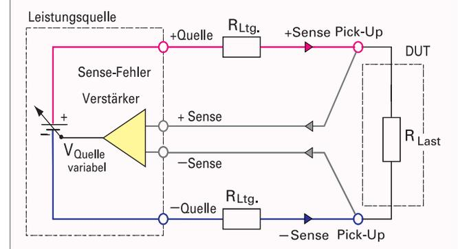
Die äußeren durchsichtigen Buchsen ⑯/⑰ sind SENSE-Eingänge. Mit den beiden Senseleitungen lassen sich Spannungsabfälle auf den Lastzuleitungen ausgleichen. Diesen Spannungsabfall gleicht das HM8143 automatisch aus, so dass am Verbraucher die tatsächlich eingestellte Spannung anliegt. Schließen Sie an den SENSE-Eingängen ⑯/⑰ zwei separate Messleitungen parallel zu den Anschlussleitungen der Last an.
